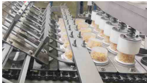
. Colocador de sobrecopas . Overcups dispenser
