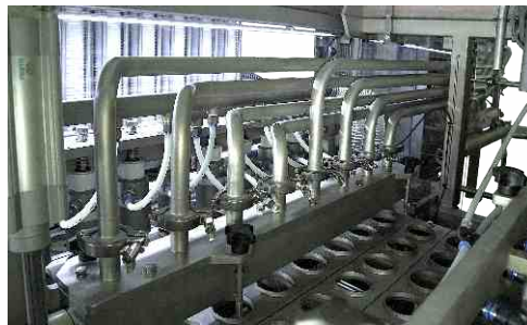
. Cabecal dosificador . Filling head
