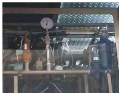
. Opcional: Sistema de desinfección de envases mediante H2O2 . Optional: Cups disinfection system using H2O2
