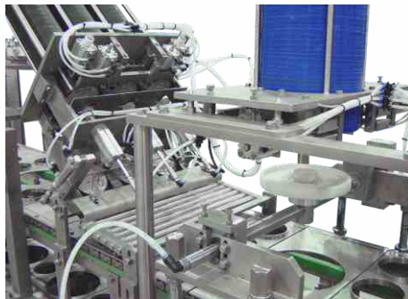
. Colocador y pión de tapas plásticas . Plastic lids dispenser and capper
