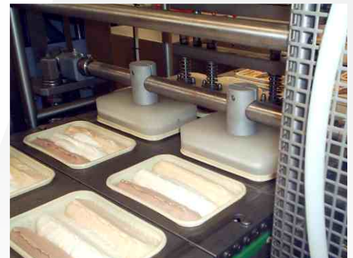
. Colocador de tapas . Plastic lids dispenser
